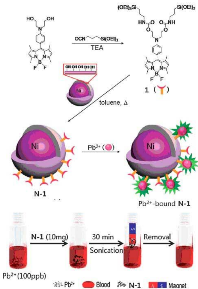
شکل ۱۷ سنتز نانوسیلکا مغناطیستی برای جداسازی سرب از خون
