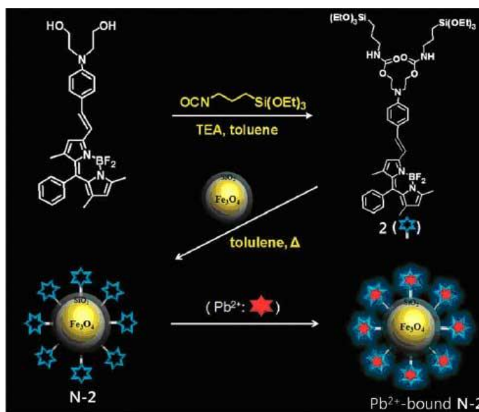
شکل ۱۳ حسگر برای شناسایی کاتیون سرب از طریق فلورسانس
